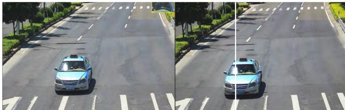
电荷 / 电压转化，信号放大，转化为数字信号，当 CCD 中的一个点的感光过曝，电荷溢出时，由于 CCD 传感器的特殊结构 (CCD 的电荷在信息读取时需要以行的方式移动)，导致电荷向上下流动，从而导致上下出现亮条。
